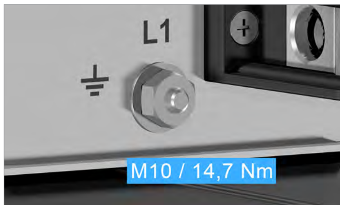
Fig. 5.16: PE connection
